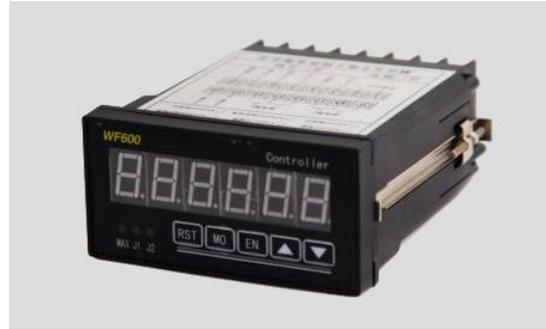
**注：在单圈脉冲数检测试验中旋转编码器轴，仪器即可测试出该编码器的单圈脉冲数，第一圈检测脉冲数为系统清零位置点，脉冲数不具备参考意义，从第二圈开始有效。**
