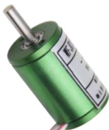
WFJD15 系列微型无触点式角度传感器工作原理是通过电磁感应原理，将角度转化成电信号的传感器。当被测物体将角度传递给传感器旋转轴时，WFJD15 角度传感器即输出一个与转动角度成正比例的电信号。本系类产品采用硬质铝合金材料制作外壳；采用霍尔式无触点技术，因为 WFJD15 系列角度传感器具备无触点式角度传感器的优点，并使用高品质不锈钢高速轴承等高品质部件，使得其测量时摩擦阻力减到最小，不会因为测量部件的表面磨损而导致测量精度下降，使用寿命理论上可无限长；该产品结构紧凑，体积小，可选择性强，分辨率高，转动顺滑，动态噪声小，适用于除电磁干扰外的水、油、振动冲击等恶劣的工业环境，是一款高性价比的非接触式角度传感器。
