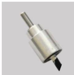
W12S3 系列微型编码器工作原理是通过电磁感应原理，将角度转化成电信号的传感器。采用霍尔式无触点技术，因而该编码器具备高精度、体积小优点，并使用高品质不锈钢高速轴承等高品质部件，使得其测量时摩擦阻力减到最小，不会因为测量部件的表面磨损而导致测量精度下降，使用寿命理论上可无限长；该产品结构紧凑，体积小，分辨率高，转动顺滑，动态噪声小的性能，是一款高性价比的磁电式微型编码器，具备防水，防尘功能，可野外水下使用。
